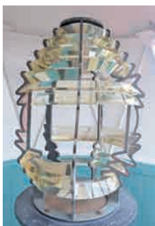
fig9：旧和田岬灯台の フレネル式レンズ
