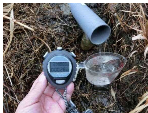
後法 漏水量測定(近景)
