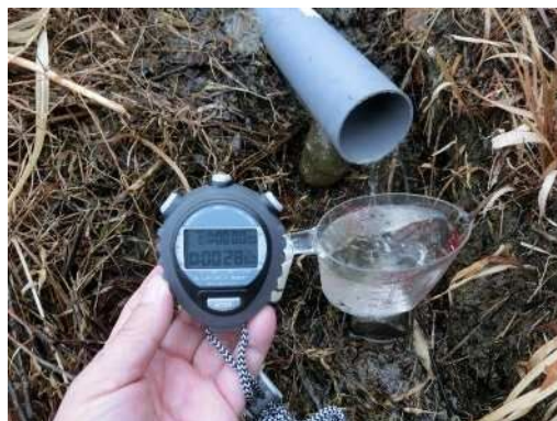
後法 漏水量測定(近景)
