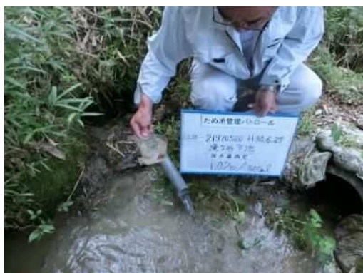
後法 漏水量測定(遠景)
