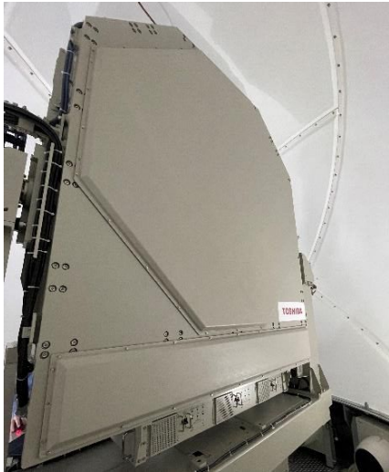
てつとう せっち 鉄塔の上のレドーム内に設置された レーダーのアンテナ部
