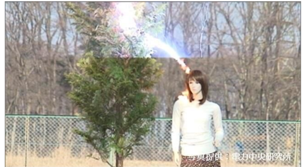
マネキンを使った側撃雷の実験 （写真提供：電力中央研究所）（気象庁ホームページより）
