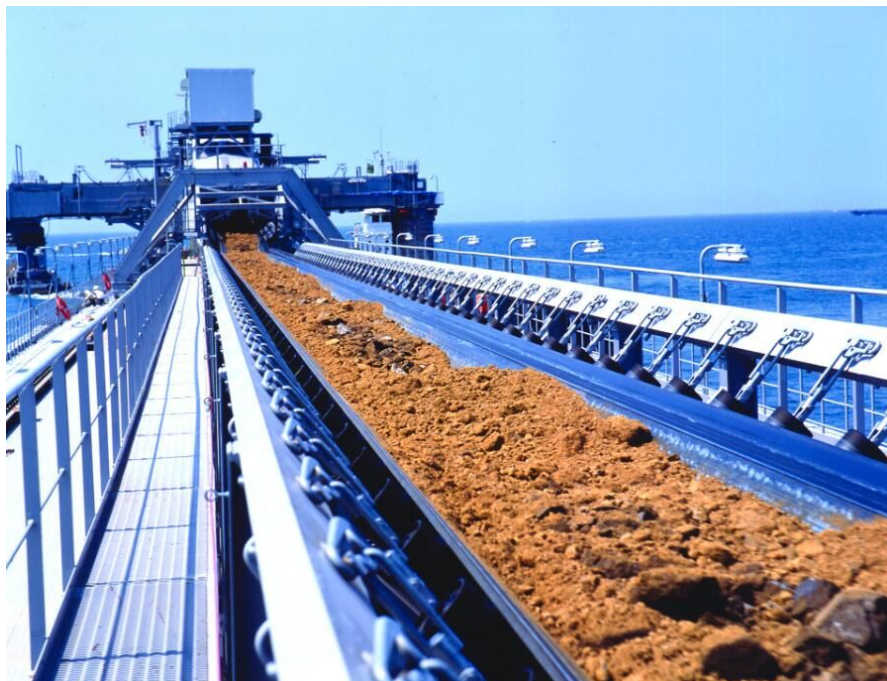
人工島の埋め立てや採石場などで土砂やがれきを運搬するコンベヤベルト
