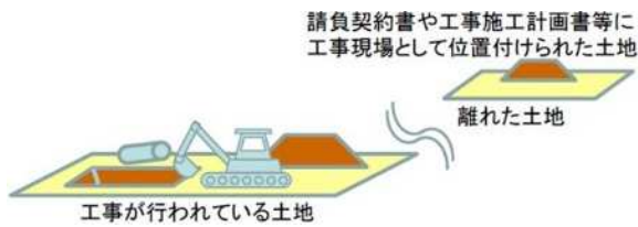
図 1-11 「工事の現場」の考え方
