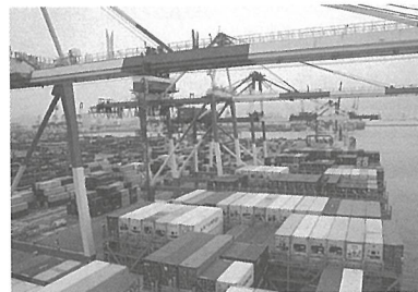
PC-16/17 22列対応高規格ガントリークレーン
