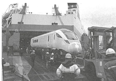
六甲アイランドRL-1で海外向け 新幹線車両の積み込み
