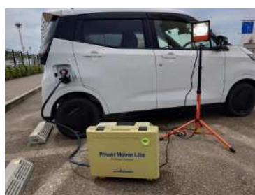
<外部給電器を用いた家電利用>
