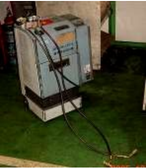
■フロン類回収設備
