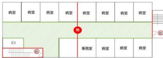
第10-13図：平面を大きく複数に防火区画した水平避難対策例①。
