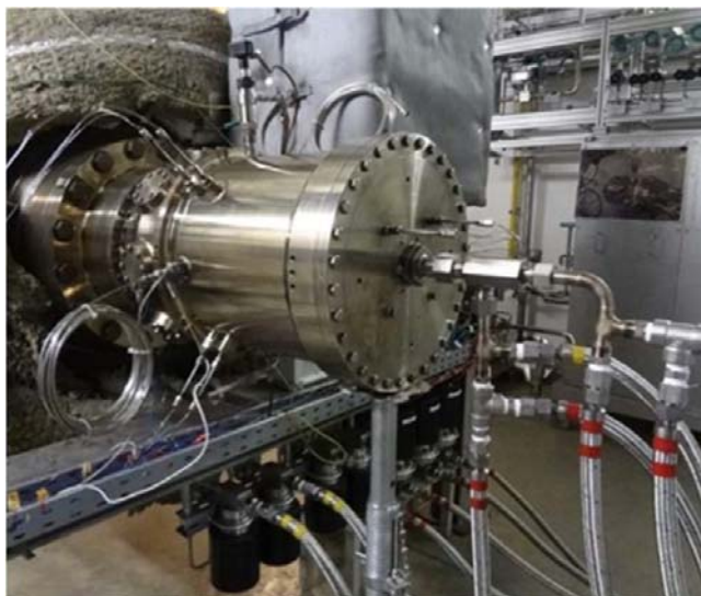
水素専焼DLE燃焼器試験 (アーヘン工科大学)
