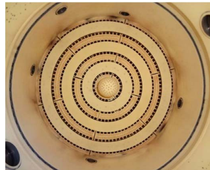
2時間の試験後の燃焼器内部 * 残存酸素16%換算値
